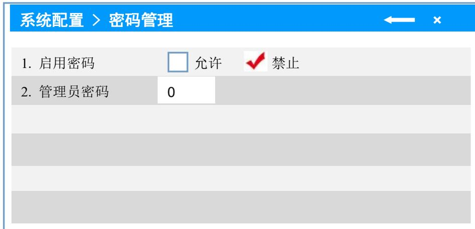
在此页面，可以使能密码功能，并可以自行设置管理密码，但设置的密码必须记牢。如果选择“允许”，在主页面按[产品]或[菜单]键时将要求输入设置的密码，如果忘记设置的密码，可使用万能密码：68420。
